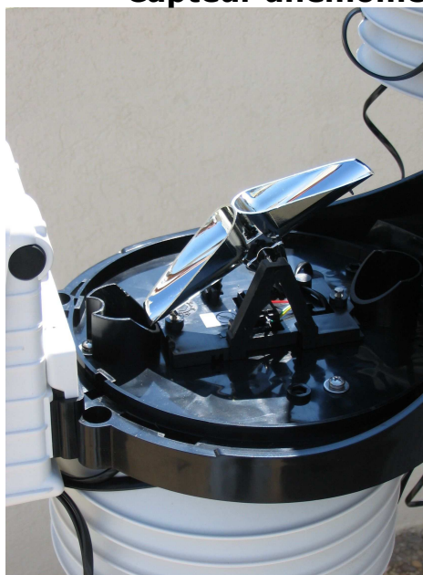
Détail des augets basculeurs dans le pluviographe
