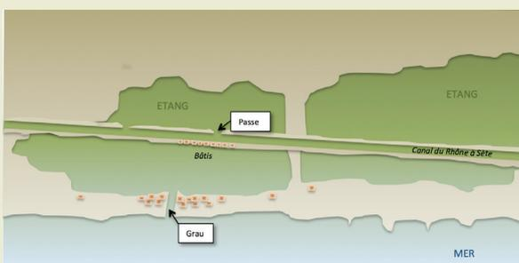
Les résultats des modélisations réalisées mettent en évidence des débits d'échanges variables d'un scénario à l'autre. Les débits maximum varient ainsi de 40 m<sup>3</sup>/s à 250 m<sup>3</sup>/s pour les graus de Frontignan (port et canal), du Prévost et du Lez, alors que le grau de Carnon présente une amplitude bien moins importante, allant de 20 à 70 m<sup>3</sup>/s.
