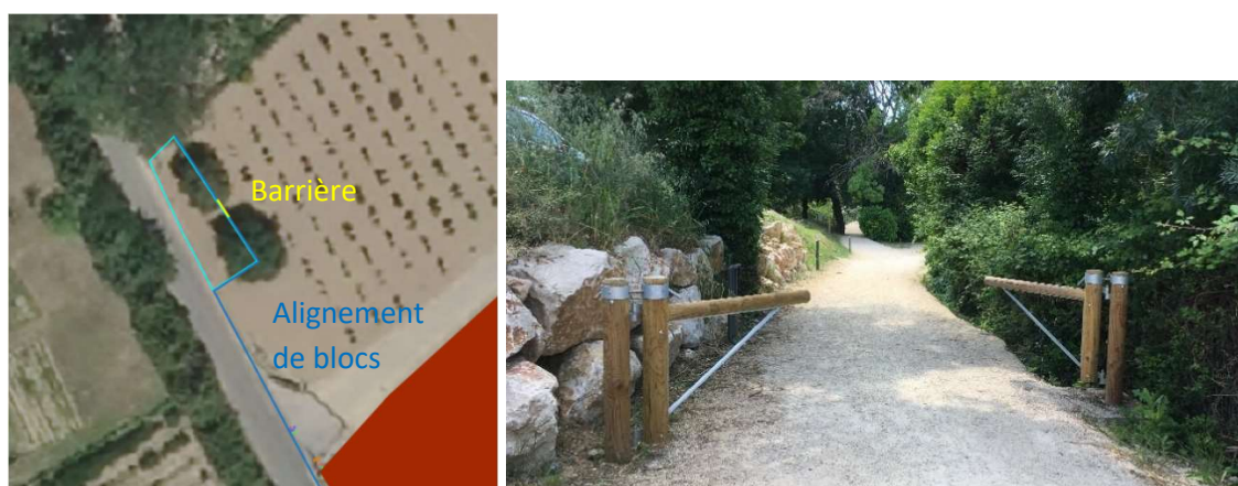
Figure 11 : Exemple de système de fermeture en chicanes (position semi-ouverte pour le passage de véhicules)
